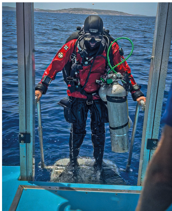
Un ascenseur à plongeur, permet aux « tekkies » de remonter sur l'embarcation sans effort malgré un équipement encombrant.
